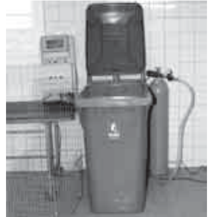
Bild: Die Tötungstonne mit Gasflasche (rechts) und Mess-/Regelgerät (links)
